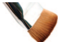
Dégraissage avec brosse
